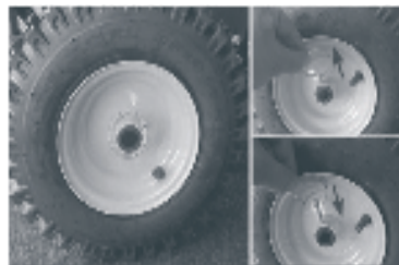
Установка шплинта на левом колесе
