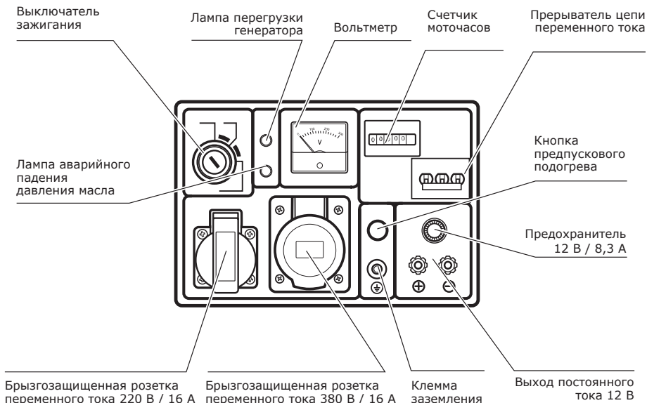
Рис. 3. Схема панели управления генератора УГД-5300ЕТ, УГД-6000ЕТ/3 кВт, УГД-6000ЕТ/4 кВт.
