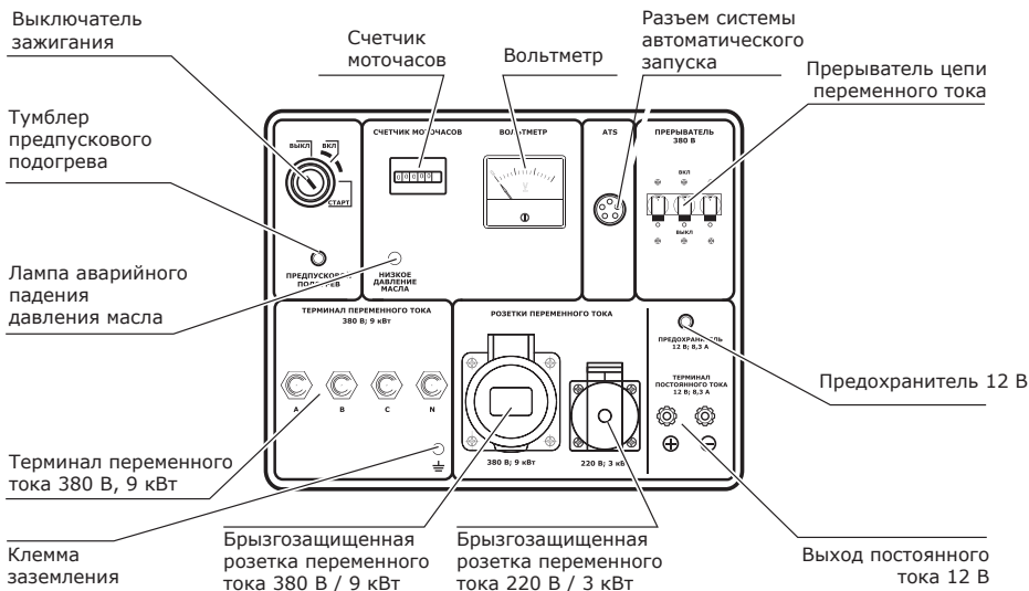
Рис. 5. Схема панели управления генератора УГД-1000ЕТ
