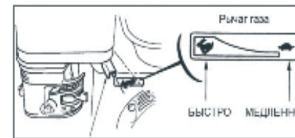
Установка рычага газа
