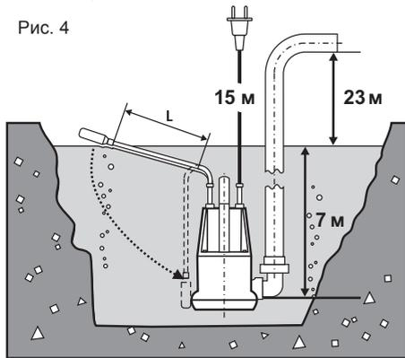
**ПРИМЕЧАНИЕ!** Уровни включения и выключения насоса регулируются **ОДНОВРЕМЕННО**. При установке определенного верхнего уровня (включения насоса) убедитесь, что в нижнем положении выключатель обеспечивает своевременное (до оголения водозаборных отверстий в нижней части) выключение насоса. При уменьшении длины **L** уменьшается разность уровней включения и выключения.
