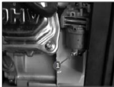
Рис. 24 Обслуживание фильтра отстойника Т-50 1. Винт
