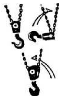
Рис. 6 Неправильное положение крюка.
