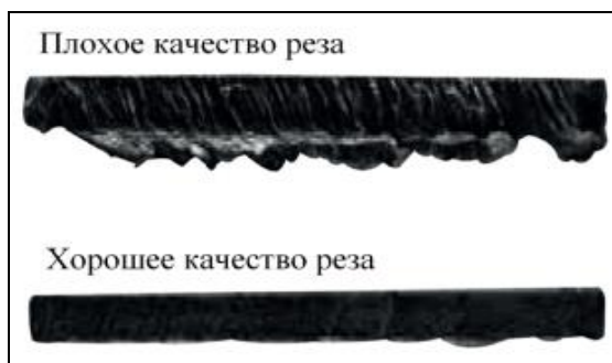
Рис.4 Влияние силы тока и скорости реза.
