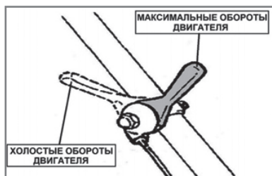
Рис. 13 Положения рычага газа а. Положение максимальных оборотов двигателя б. Положение холостых оборотов двигателя
