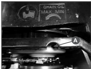
Рис. 11 Положение регулировочного винта подачи масла
