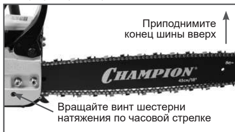
Рис. 5 Регулировка натяжения цепи
