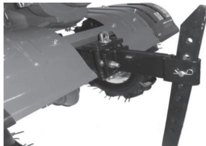
Установите колеса или фрезы на оси редуктора, зафиксируйте их стопорными пальцами, пальцы зафиксируйте шплинтами.
