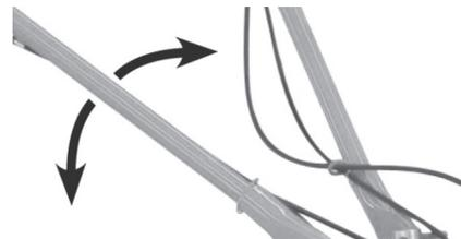
**Регулировка глубины вспашки.** Для регулировки глубины вспашки необходимо отрегулировать по высоте сошник. Вынуть штифт (5), переместить сошник (4) вверх (глубина вспашки уменьшится) или вниз (глубина вспашки увеличится), зафиксировать в требуемом положении. Правильная регулировка зависит от почвы.
