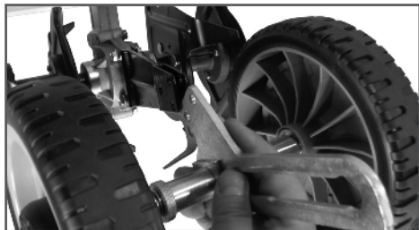
Рис. 6 Установка кронштейна колес
