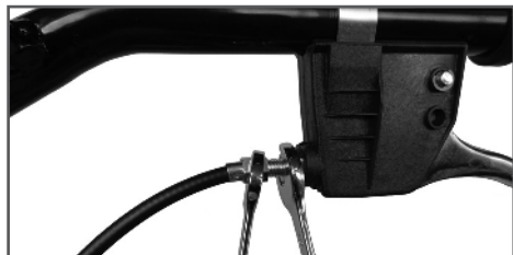
Рис. 12 Фиксация троса газа
