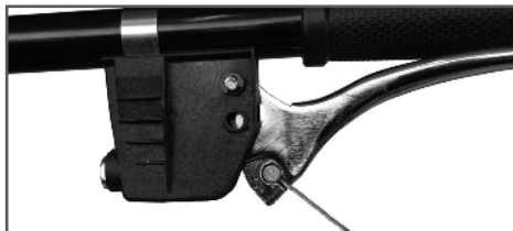
Рис. 9 Установка наконечника троса газа
