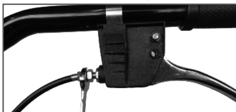
Рис. 10 Установка регулировочной муфты троса газа
