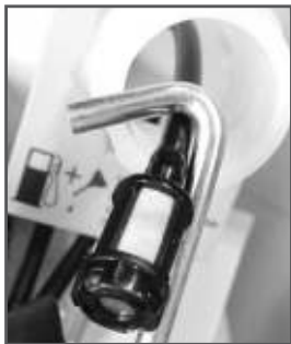
Рис. 21 Извлечение топливного фильтра
