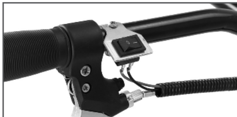
Рис. 13 Подключение проводов к выключателю зажигания
