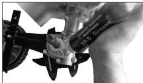
Рис. 24 Добавление смазки в корпус редуктора
