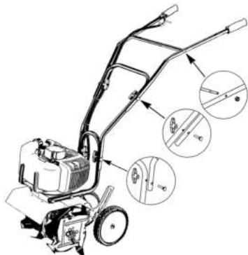
Рис. 8 Установка рукояток управления
