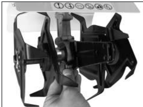
Рис. 5 Установка кронштейна сошника
