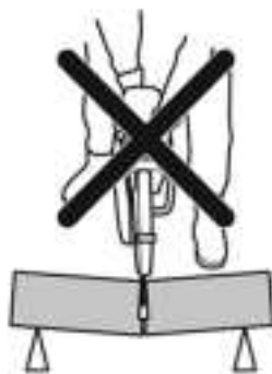
Рис. 15 Отдача при защемлении диска
