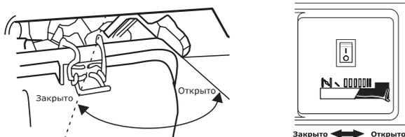
**ВНИМАНИЕ! Управление приводом воздушной заслонки на разных моделях бензиновых генераторов SKAT отличается. Смотрите рисунки.**
