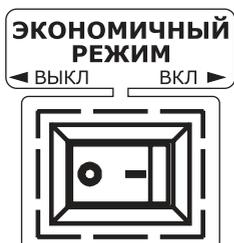
Использование режима «ECO» допустимо только в случае подключения омических потребителей (пункт 3.2.2) и только в случае, если их мощность не превышает
