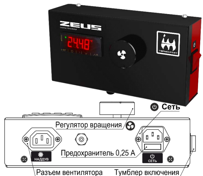
Рис. 11 Панель управления котла - ZEUS
