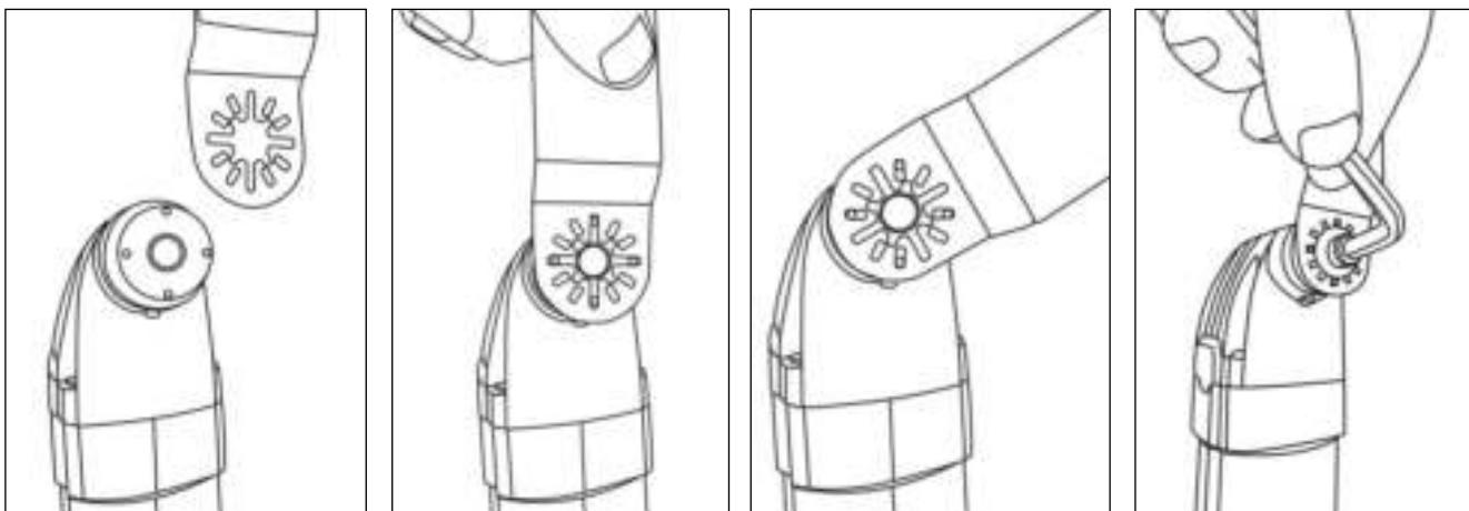
Рис.2 Установка насадки и затяжка болта крепления насадки
