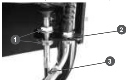
Рис. 10 Крепление оболочки троса включения хода
