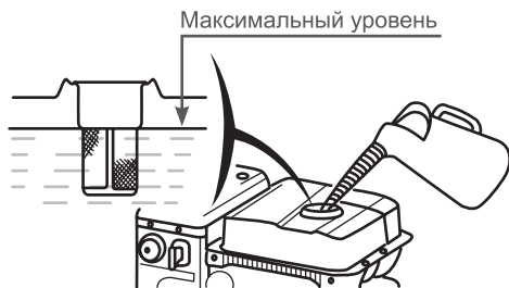
Рис. 28 Максимальный уровень топлива в топливном баке
