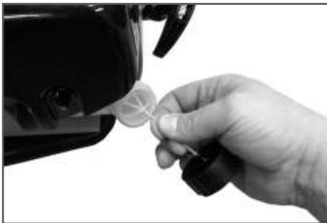
Рис. 14 Снятие крышки топливного бака
