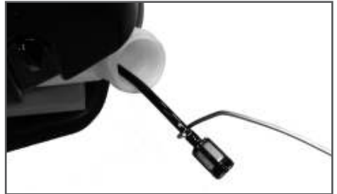
Рис. 15 Извлечение топливного фильтра
