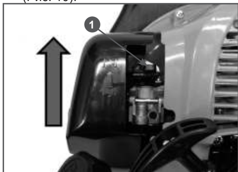
Рис. 10 Воздушная заслонка карбюратора закрыта
