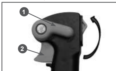
Рис. 12 Фиксатор курка газа и курок газа
