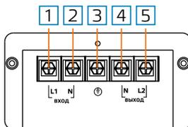
1. Клемма подключения подводящего фазного проводника
