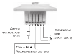
Рисунок 4. Схема подключения к терморегулятору
