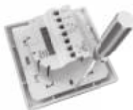
Рисунок 5. Демонтаж лицевой панели
