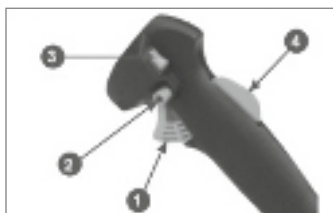
Рис. 7 1 - Рычаг газа, 2 - Фиксатор рычага газа, 3 - Выключатель зажигания, 4 - Рычаг предохранительный
