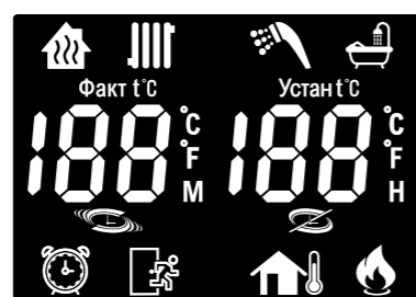
Рисунок 8. Дисплей пульта управления NCTR-60R.
