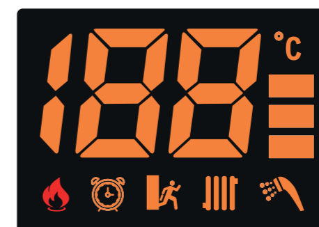
Рисунок 6. Дисплей панели управления P-100R.
