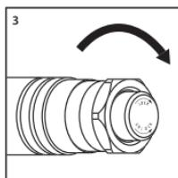
3. Закрутить фиксатор регулировочной рукоятки ключа, повернув по часовой стрелке в направлении Lock.
