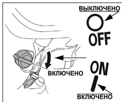
Рис. 12 Выключатель зажигания в положении «Включено»
