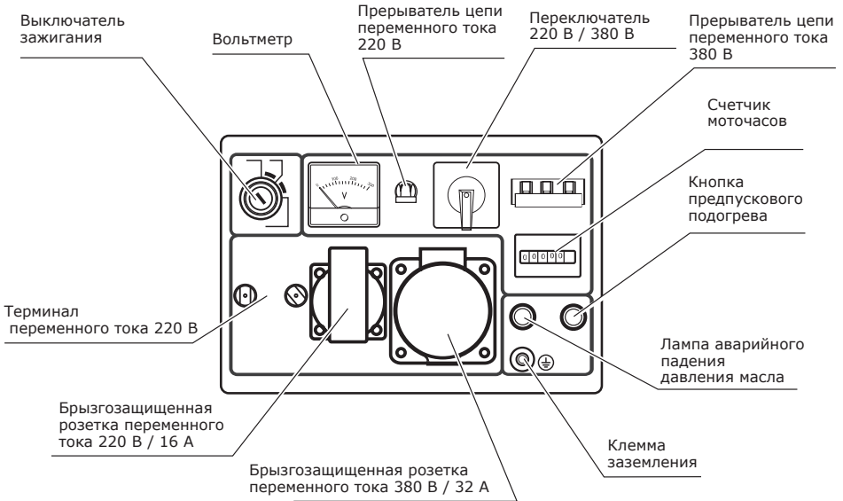
Рис. 3. Общий вид генераторов УГД-11500Е PROFF, УГД-11500ЕТ PROFF, УГД-15000Е PROFF, УГД-15000ЕТ PROFF.
