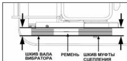
Рис. 32 Проверка плоскости шкивов и ремней
