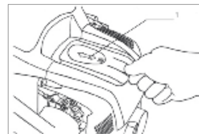
Рис. 14 1. Крышка свечи зажигания
