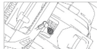
Рис. 14 1. Крышка свечи зажигания
