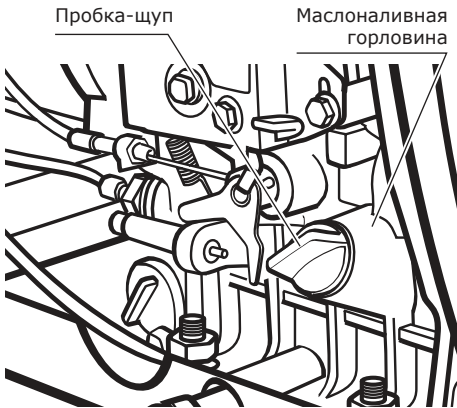
Рис. 11. Заполнение масляного картера и контроль уровня масла
