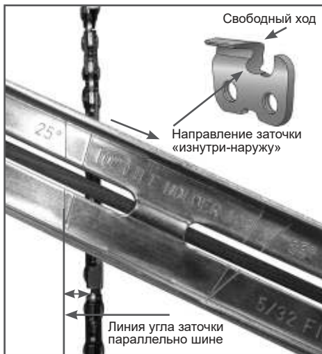
Рис. 22 Расположение линии угла заточки
