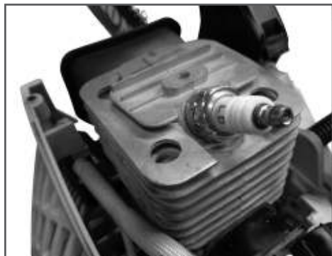
Рис. 28 Охлаждающие ребра цилиндра
