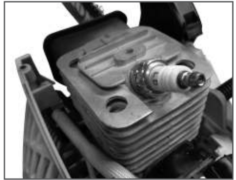
Рис. 29 Охлаждающие ребра цилиндра
