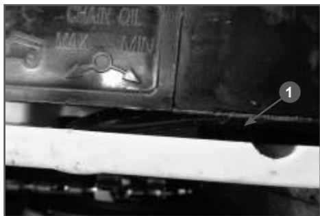
Рис. 8 Винт регулировки подачи масла 1. Винт регулировочный
