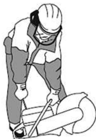
Рис. 7 Положение оператора при запуске двигателя
