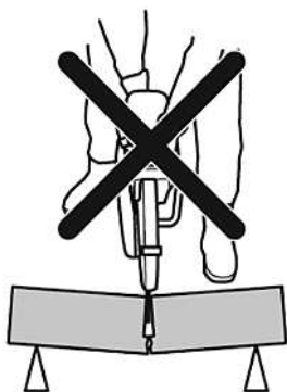
Рис. 14 Отдача при защемлении диска
