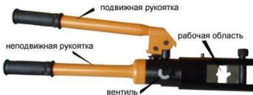
Рис.1 - Составные части опрессовщика кабеля
