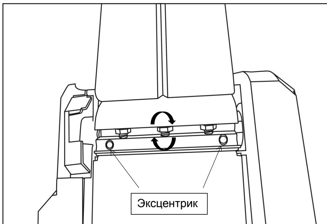
Рис.3 Замена режущего ножа.
