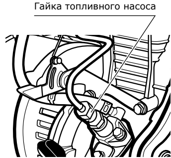
Рис. 14 . Удаление воздуха из топливной системы двигателя
