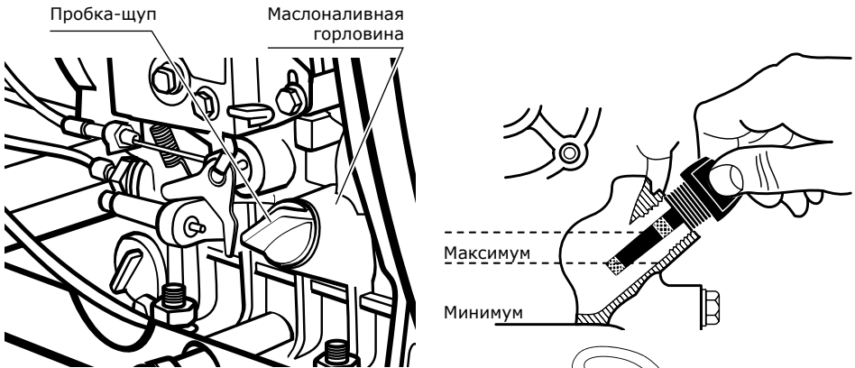
Рис. 9. Заполнение масляного картера и контроль уровня масла
