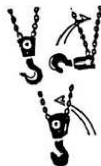
Рис. 6 Неправильное положение крюка.
