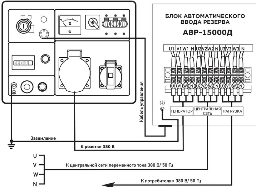
**Рис. 15. Схема подключения блока АВР-15000Д и однофазного генератора на 220 В к трехфазной сети**
