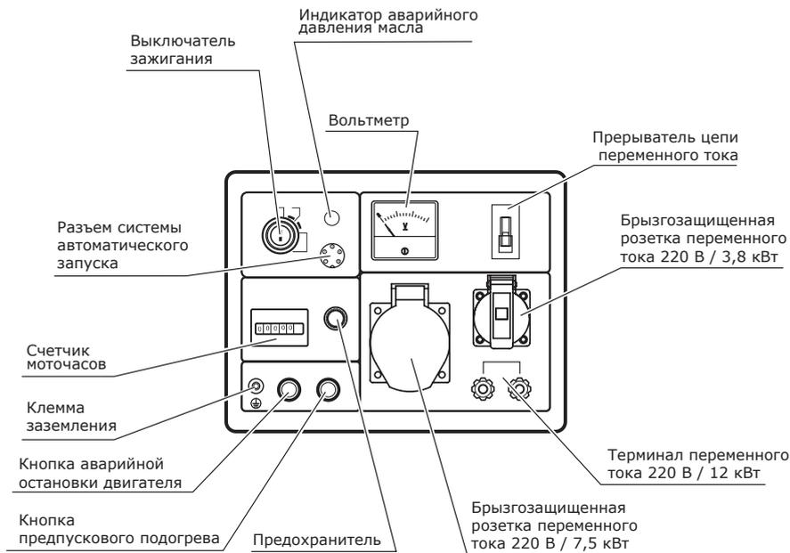
**Схема панели управления генератора УГД-12000ЕТ РЕЗЕРВ.**
