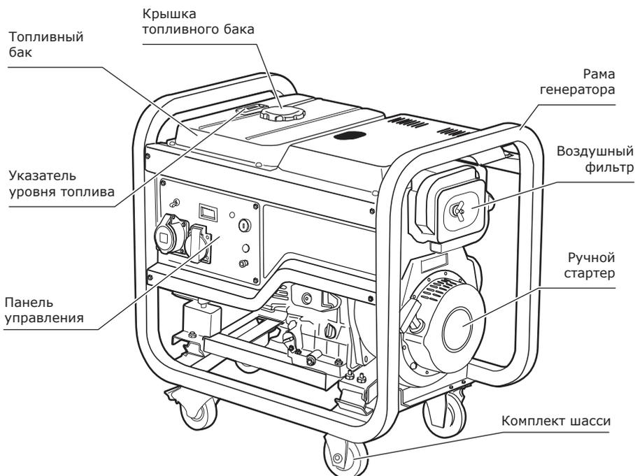
**Рис. 2. Схема панели управления генераторов УГД-3000Е РЕЗЕРВ, УГД-4500Е РЕЗЕРВ, УГД-5500Е РЕЗЕРВ, УГД-6500Е РЕЗЕРВ, УГД-7000Е РЕЗЕРВ, УГД-8000Е РЕЗЕРВ.**
