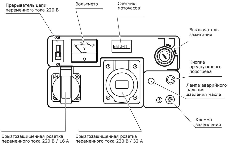
**Рис. 3. Общий вид генераторов УГД-12000Е РЕЗЕРВ, УГД-12000ЕТ РЕЗЕРВ.**
