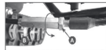
Регулировка троса привода хода
