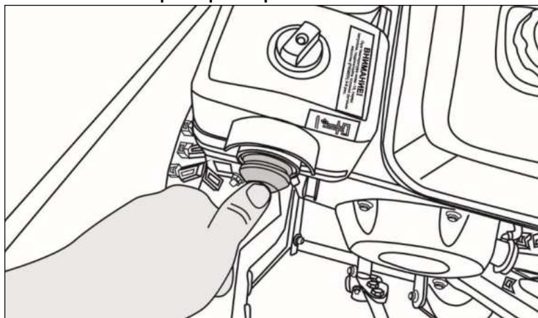
Рис. 37. Накачка топлива в карбюратор.
