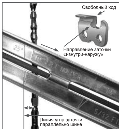
Рис.22 Определение угла заточки
