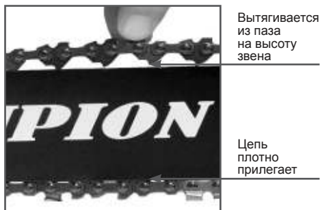
Рис. 5 Регулировка натяжения цепи
