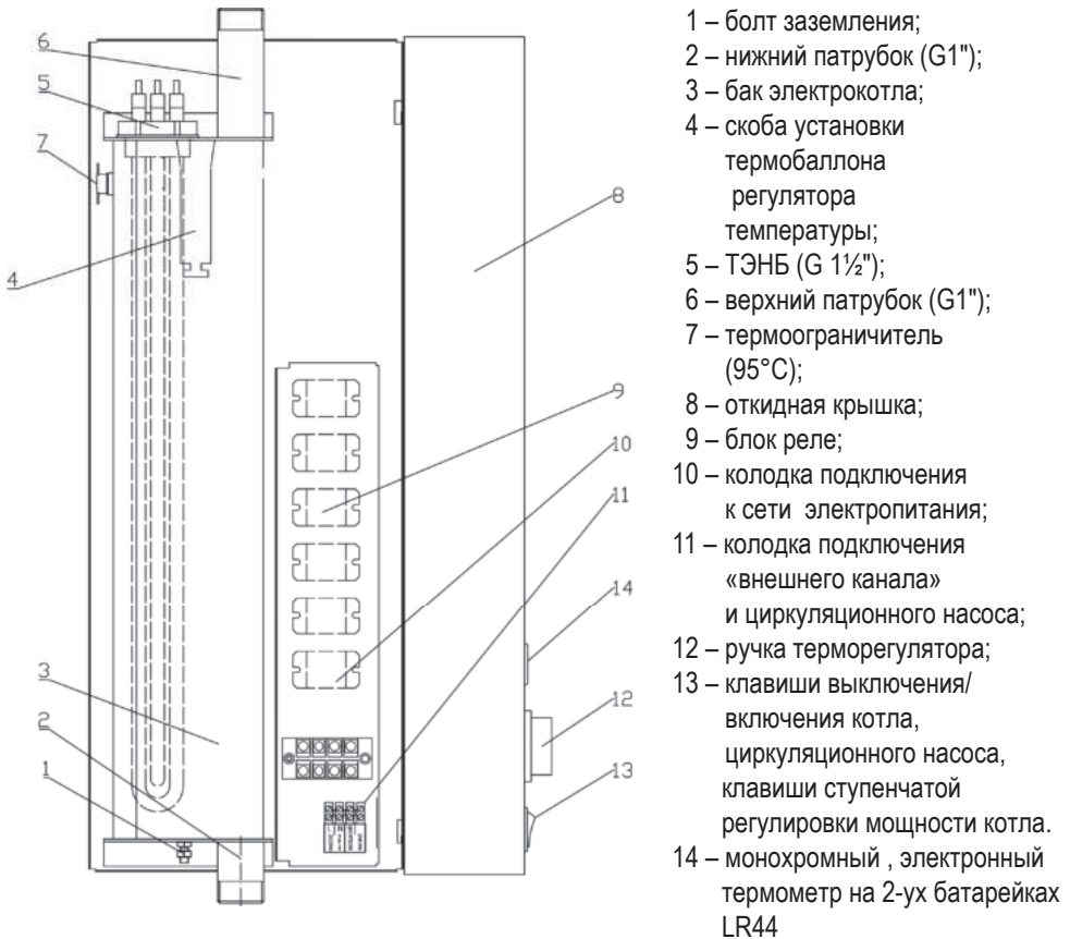
Рис. 1. Устройство электрокотла (крышка открыта).
