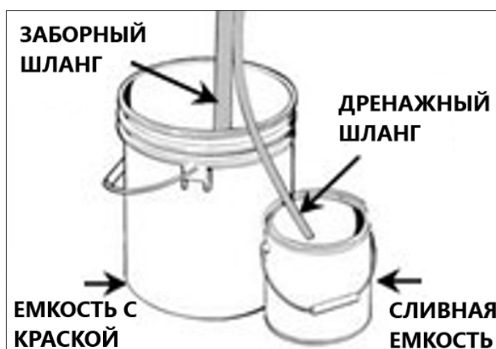
Рис. 14. Разделение заборного и дренажного шлангов
