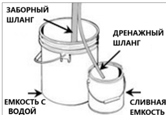
Рис. 10. Промывка перед первым применением
