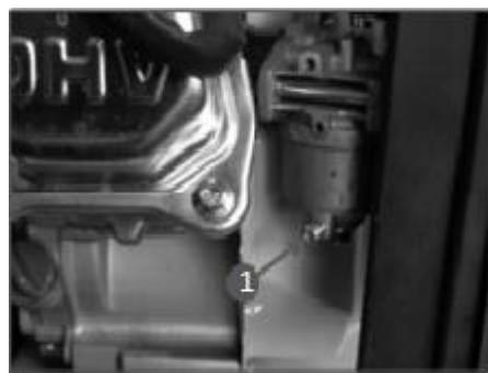
Рис. 24 Обслуживание фильтра отстойника Т-50 1. Винт
