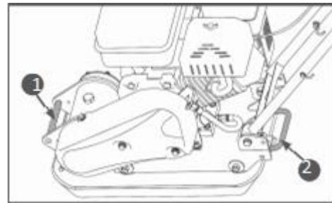
Рис. 36 Рукоятки транспортировочные
