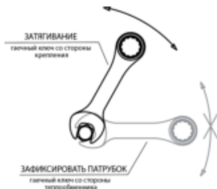
Рис. 5. Подключение к системе подачи теплоносителя
